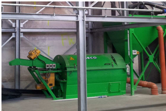
FLOTMAT-03-Vibro mit Vorabscheider und Vibrorinne
