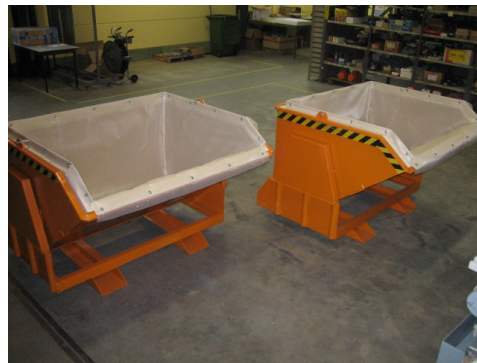
ECON-Kippcontainer für einfache Entleerung mit dem Gabelstapler
