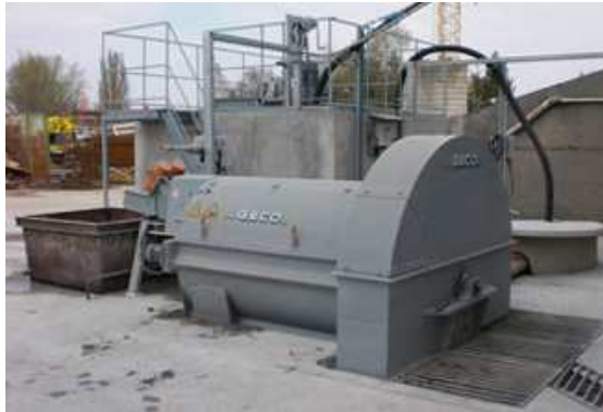
FLOTMAT-03-KOMBI mit Becken über Bodenniveau
