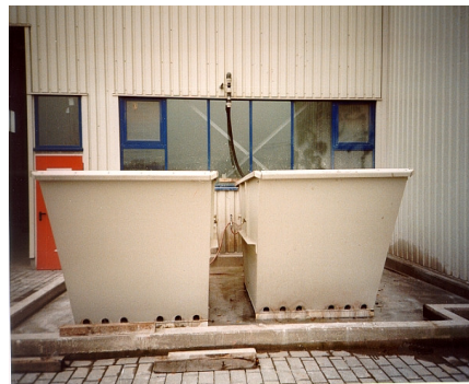
Effiziente Doppellösung in einem Betonsteinwerk. Eine zusätzliche Verdichtung des Schlammes wird durch den Einsatz von zwei abwechselnd befüllten ECON Einheiten erzielt
