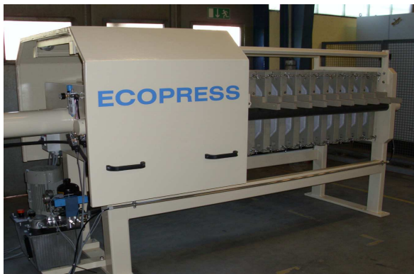
Vollautomatische Filterung durch tropfdichte Ausführung und Füllzeitüberwachung
