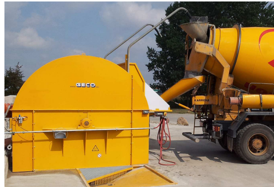
FLOTMAT-15-Kombi Aufgabebereich für 2 Fahrmischer mit Spülgalgen
