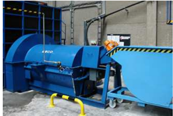
Eine steigende Entwässerungsrinne trägt den Mischkies aus.
